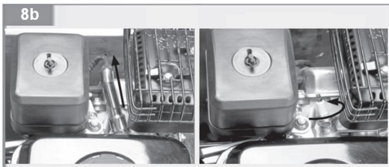
1. Снимите со свечи колпачок высоковольтного провода.
